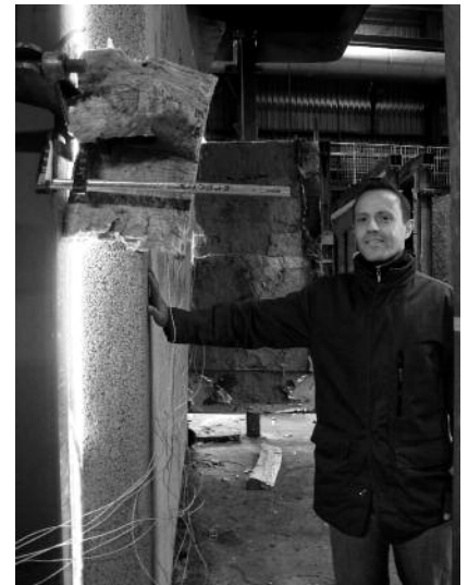
6 Stunden Brandbelastung mit über 1.200°C führt auf der Außenfläche lediglich zu Temperaturen zwischen 40°C und 100°C.
